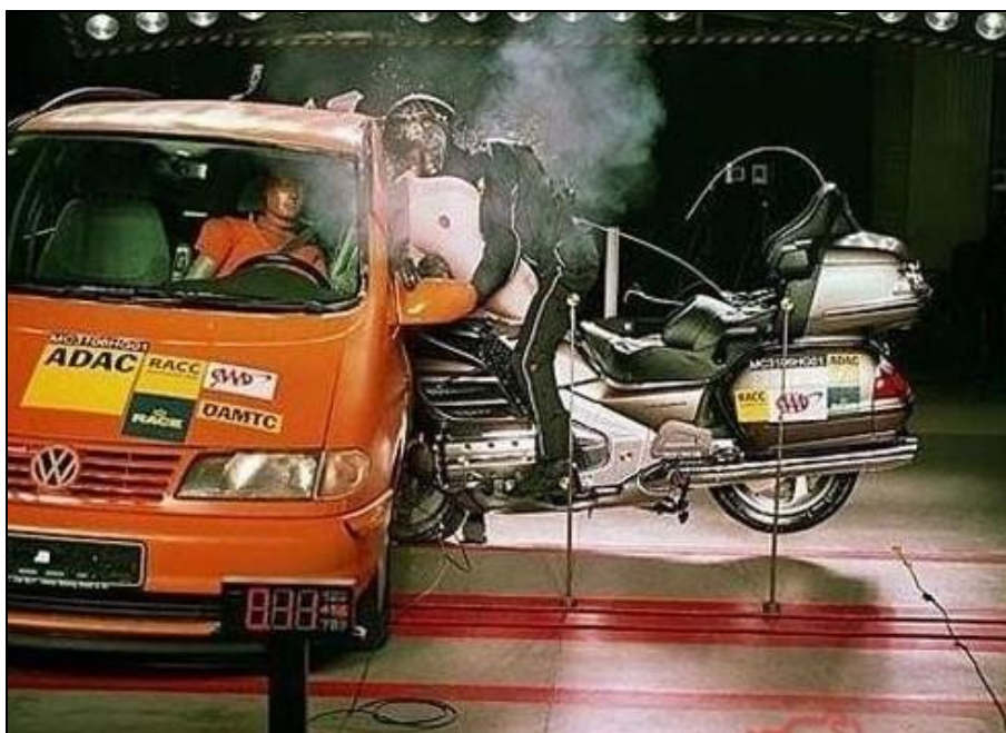
Figura 2 - Crash test dell'Honda Gold Wing con airbag
