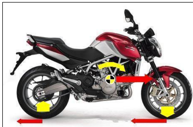
Figura 51 - Trasferimento di carico in frenata
