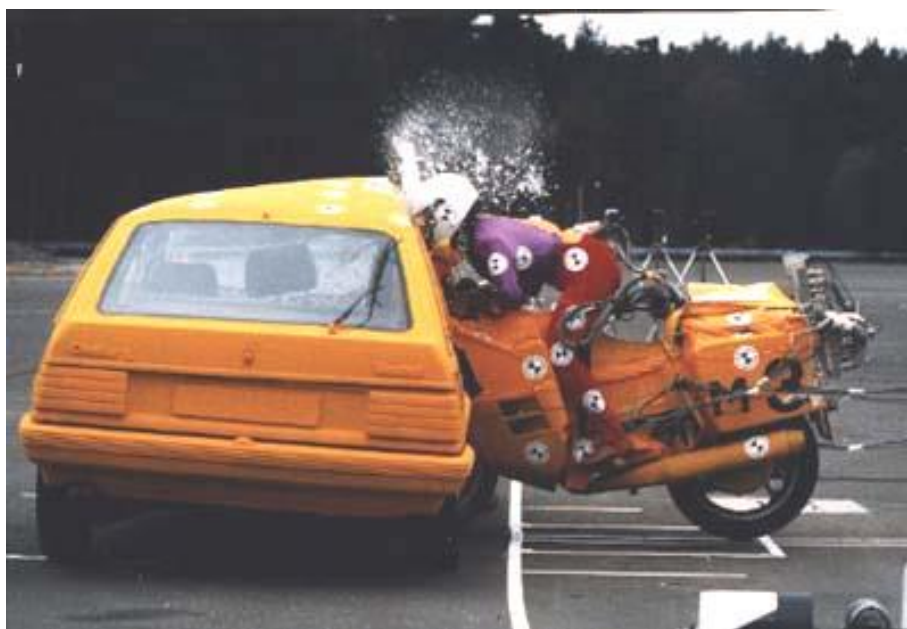
Figura 1 – Crash test di una moto contro un'auto
