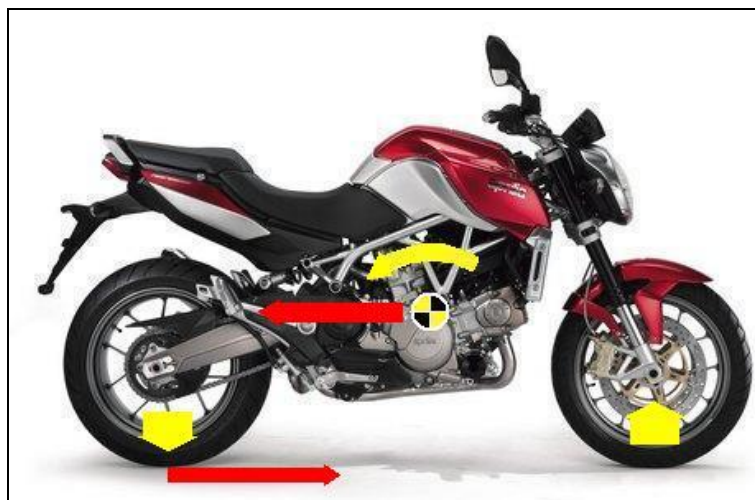
Figura 49 - Trasferimento di carico in accelerazione
